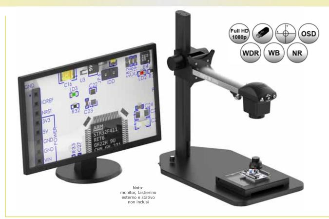
La versione Vesa dei sistemi Inspex Full HD rappresenta la soluzione ideale quando si necessita di poter collocare a varie altezze e distanze la telecamera, fermo restante il campo di azione in termini di distanza tra la focale e l'oggetto da esaminare. E' altresì la configurazione ottimale per collocare il sistema lungo linee automatiche o macchinari di produzione.
